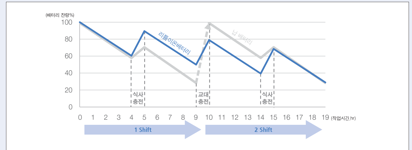
*2교대 작업장 리튬이온 배터리 장착 차량 실측 데이터 기준(4륜형 2톤급 770AH)
