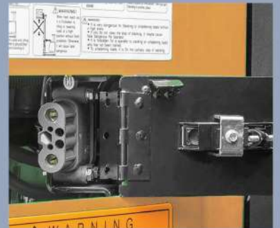
운전자 실내공간 내부에 충전 플러그가 있어, 배터리에서 플러그를 분리할 필요가 없으며, 조작의 편의성이 향상됩니다. (표준)
